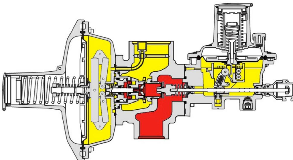
Il dispositivo di blocco può essere tarato per aumento di pressione, **Blocco di Massima pressione (OPSO)** e/o per diminuzione di pressione, **Blocco per Minima Pressione (UPSO)**.
